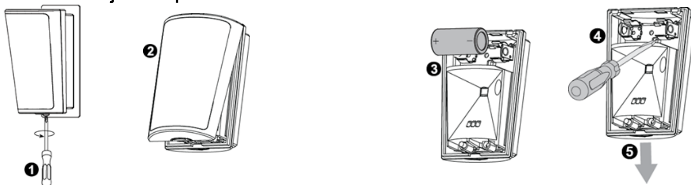
Figura 11: Desmontaje del soporte
