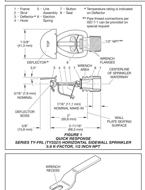
FIGURE 2 W-TYPE 9 SPRINKLER WRENCH
